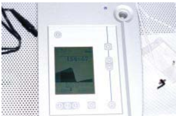
Fig. A. Aparato Osstell para el Análisis de la Frecuencia de la Resonancia
