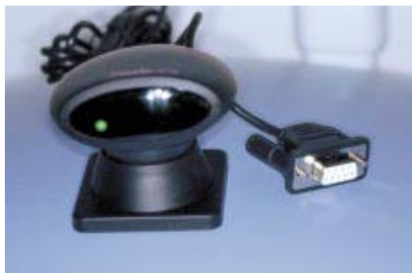
Fig. D. Los datos de las mediciones pueden descargarse a un PC sin cables mediante un dispositivo de infrarrojos.
